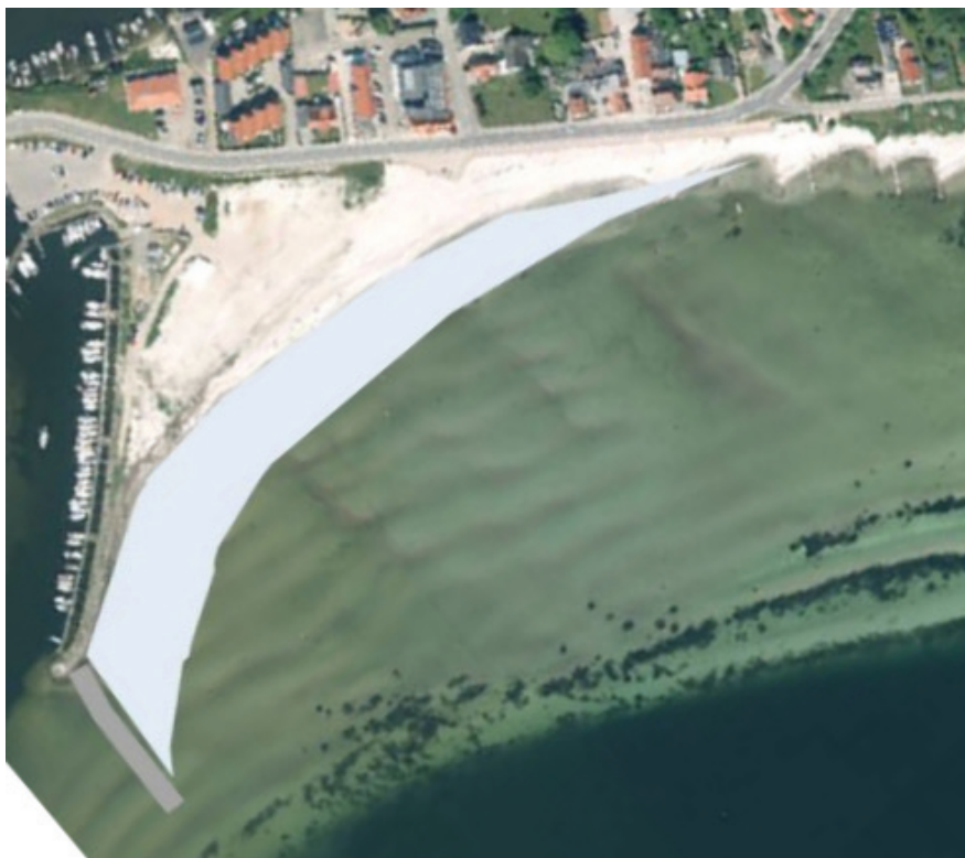
Figur 4: Alternativ løsning med forlængelse af havnemole, sandfodring og fjernelse af høfder. Det hvide område viser sandfodringen, og den grå bjælke viser den forlængede havnemole
