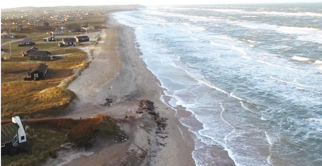
Figur 5a. Sandbuffer med bagstopper. Sedimenttransportretning er fra øverst til nederst i billedet.
