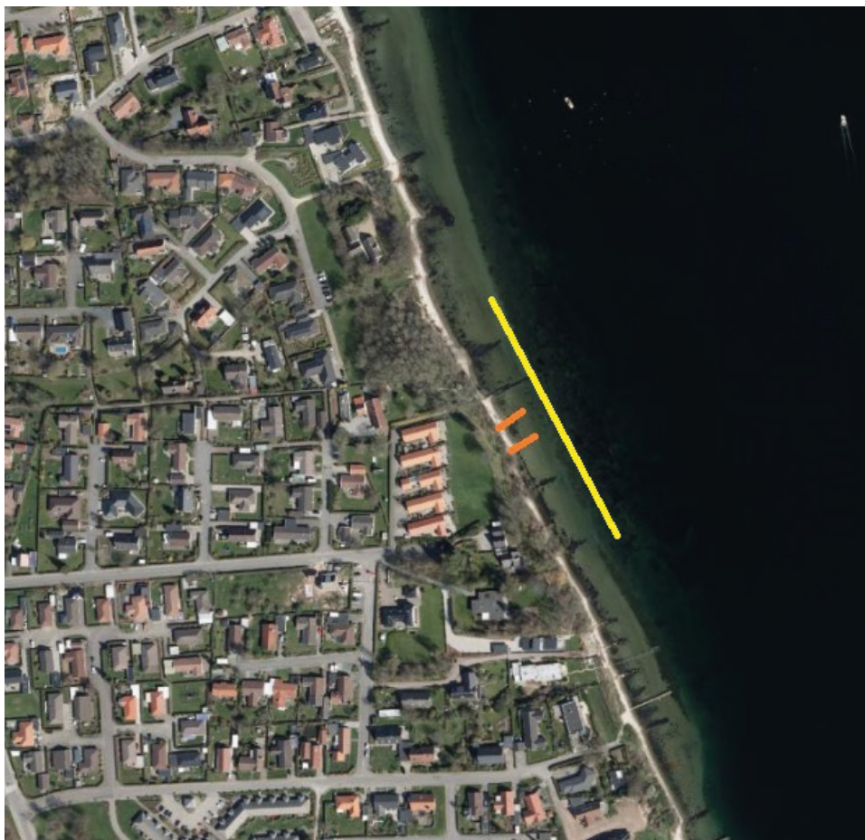
Figur 3: Alternativt forslag. De orange linjer viser placering af de to høfder og den gule linje viser strækning med fodring.
