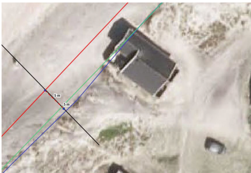
Figur 3. Skitse af fastlæggelse af akut erosion, delstrækning, rød: år 2010, grøn: år 2012, blå: år 2014 - akut erosion 5 m
