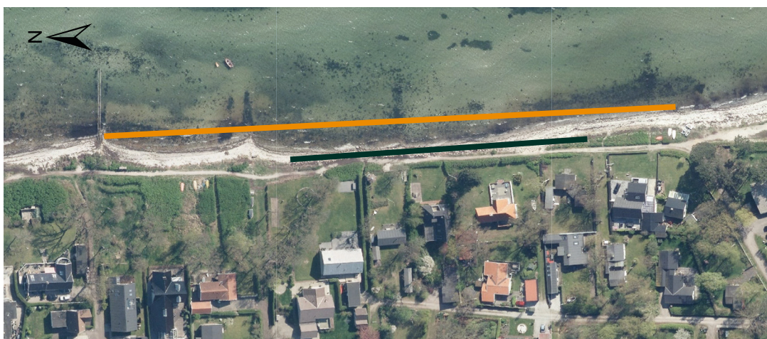
Figur 3: Alternativ løsning med sandfodring. Den grønne linje viser skråningsbeskyttelse. Den orange linje viser sandfodring
