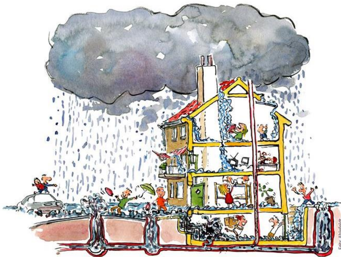
Figur 3.1 Vandets veje ind i bygningen under skybrud
