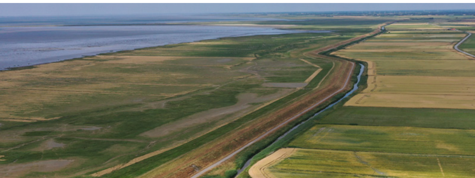
Figur 7-6 Strandengene langs vadehavet ligger oftest i en smal bræmme langs vandet, foran høje diger, som beskytter kanaler og dyrkede marker på de bagvedliggende tidligere strandenge. (Dronefoto: Torben Ebbensgaard).
