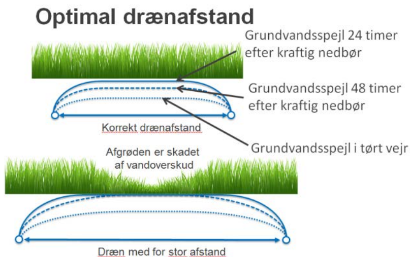
Figur 11. Figuren viser drænafstandens betydning for plantevæksten.
