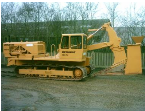
Drænplov udstyret med L-sværd. Foto: Michael Stokholm Sørensen, Danske Maskinstationer og Entreprenører.
