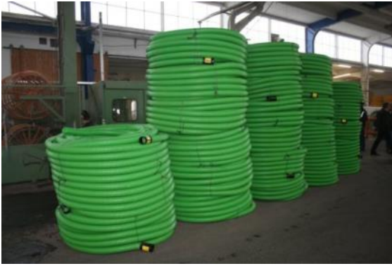
I dag bruges korrugerede plastrør til dræning af landbrugsarealer. Foto: Janne Aalborg Nielsen, SEGES
