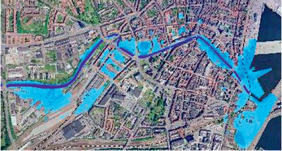
Simulering af oversvømmelser inden for Ringgaden i Aarhus midtby ved havvandstand kote 2,5 meter over havets overflade. ALECTIA
