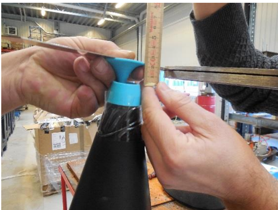
Figur 2. Eksempel fra produktudviklingen. Her justeres ventilafstanden, og udløbsdiameteren ændres ved påsætning af indsats i bunden af regnvandsventilen
