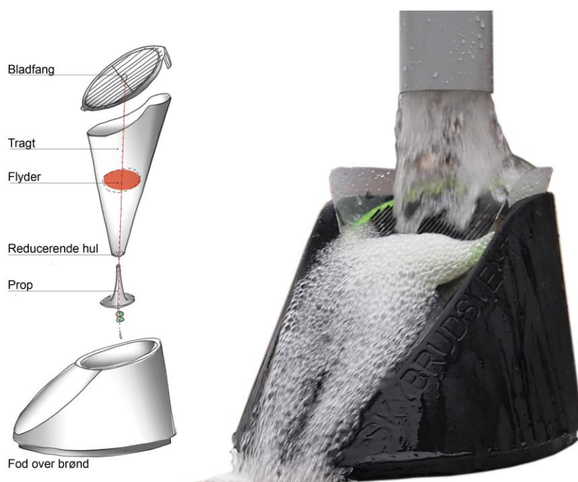
Figur 2.1. Princippet i en regnvandsventil. Ved normal nedbør ledes alt regnvandet til kloaksystemet. Under kraftig regn vil en flyder lukke ventilen, så al nedbøren afskæres fra kloaksystemet og løber af på terræn og væk fra bygningen
