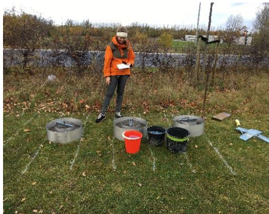
Figur 1. De 4 prøvebaner lige efter etablering, samt måling af jordens infiltrationsevne med ringinfiltrrometer
