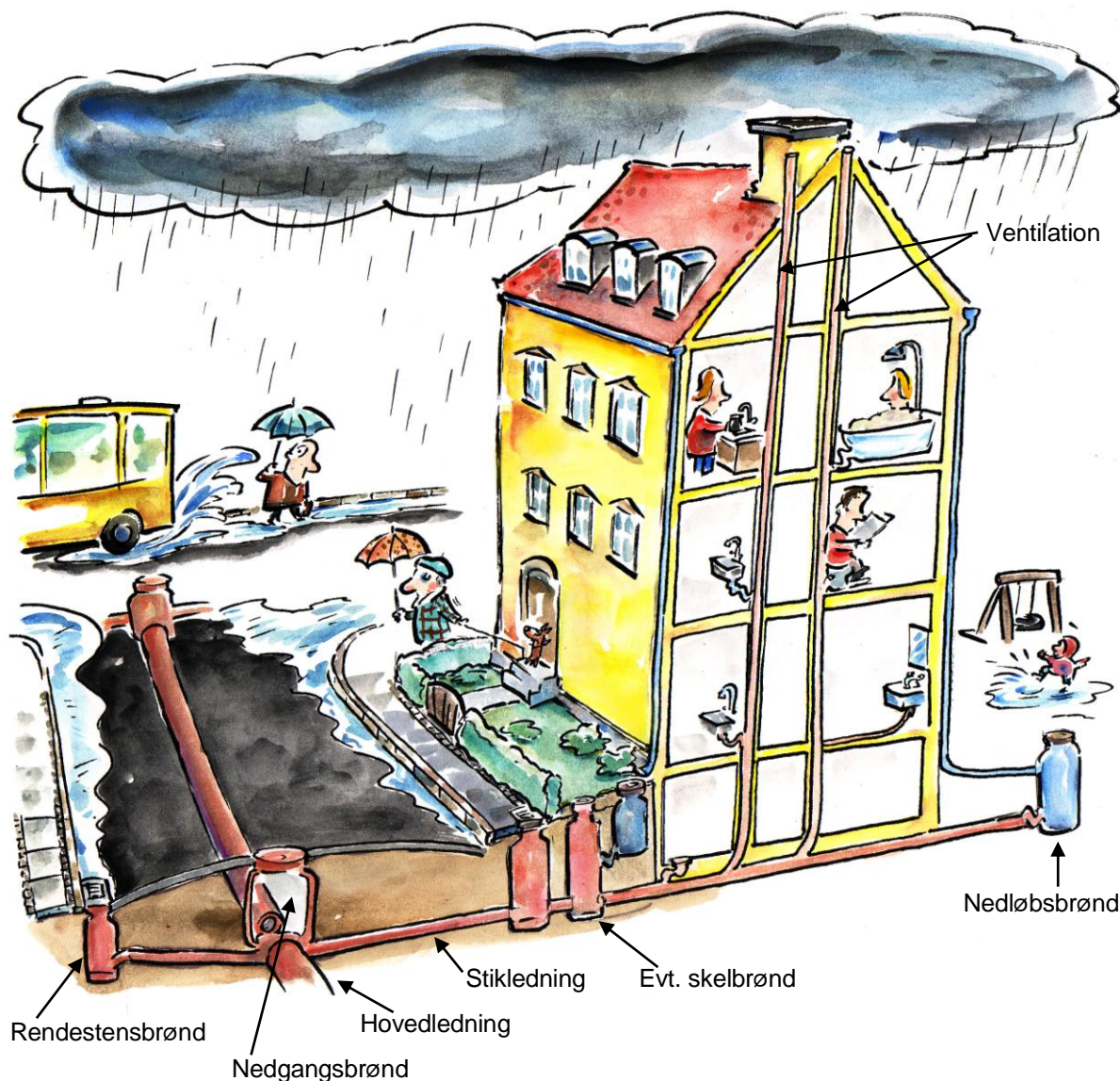
Figur 2. Afledning af spildevand og regnvand fra en ejendom gennem stikledning til hovedledningen i et fællessystem.
